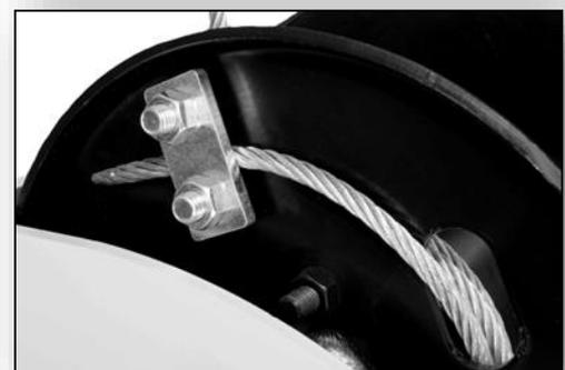
La fixation du câble est effectuée au moyen du serre-câble assemblé.
