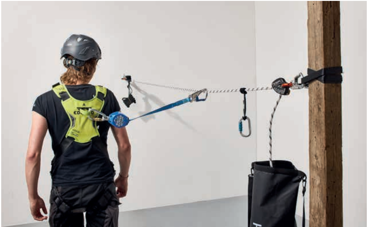
Bild 7: Lifeline in Höhe der Rückenöse gespannt mit HSG (Höhensicherungsgerät)
